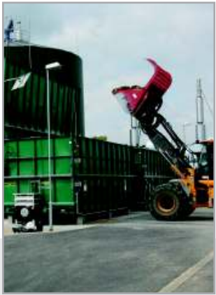
Die Silage (ca. 95 t/Tag) wird mit dem Radlader eingefüllt
